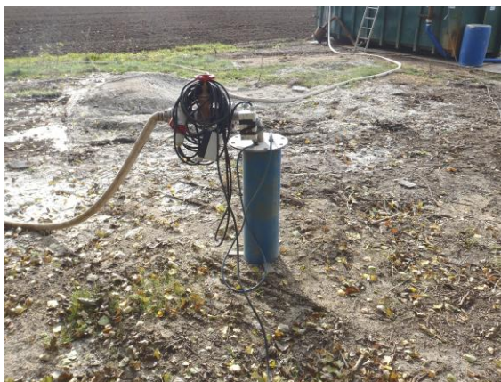
Boring renpumpes før udtagning af råvandsprøve.
